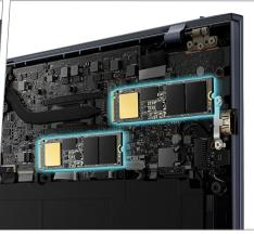
Un proceso de fresado CNC de alta Doble SSD con tecnología RAID 0 y
